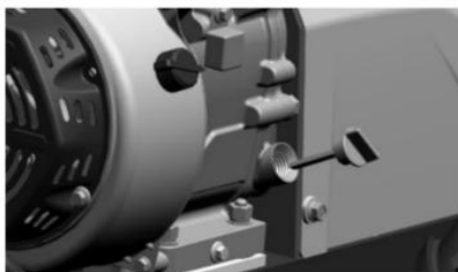
Wskaźnik poziomu oleju silnikowego
